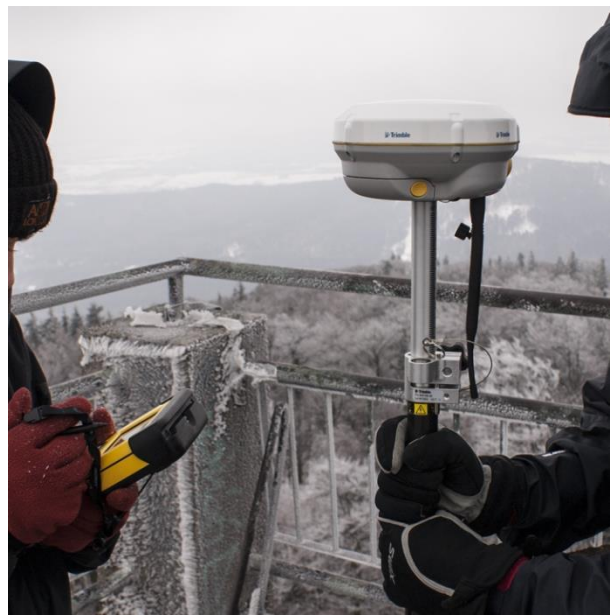
Pomiar geodezyjny szczytu wieży widokowej na Ślęży (zdj. A. Robak, 3.03.2013)
